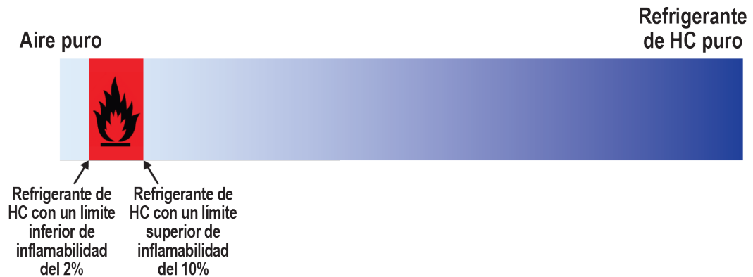
Figura 10. Ejemplo de posibles límites de inflamabilidad de refrigerante de hidrocarburos
