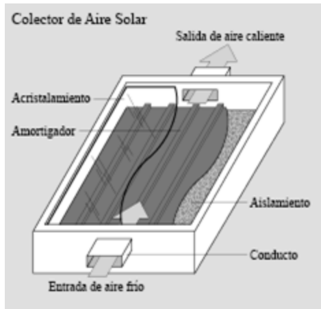
Figura 5. Colectores de aire usados para el calentamiento de espacios
