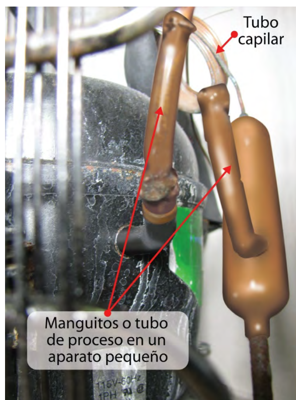
Figura I-9. Manguitos de proceso en un aparato pequeño con refrigerante no inflamable
