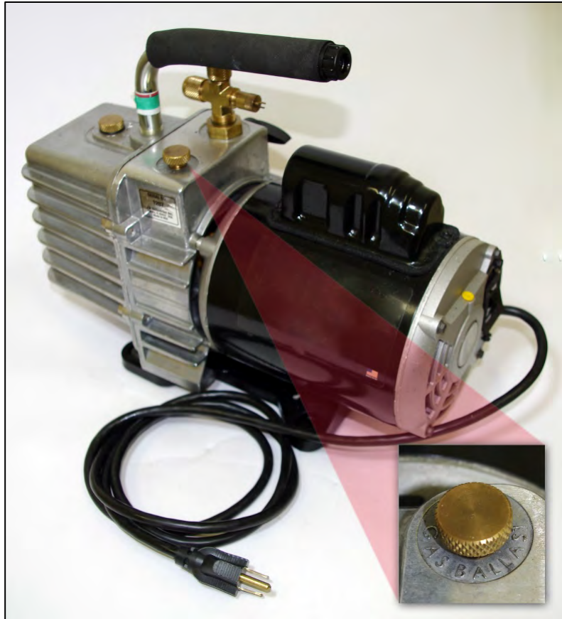
Figura C-15. Bomba de vacío de doble efecto con válvula de estrangulamiento del gas
