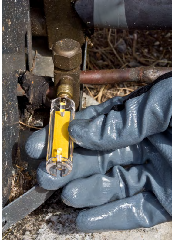
Figura C-12. Prueba QwikCheck para detectar ácidos en un sistema en funcionamiento
