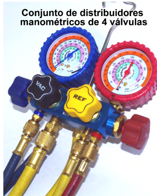
Figura C-6. Distribuidor de cuatro válvulas y cuatro mangueras
