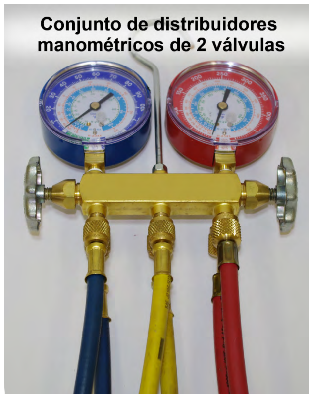
Figura C-4. Foto de un distribuidor de dos válvulas y tres mangueras
