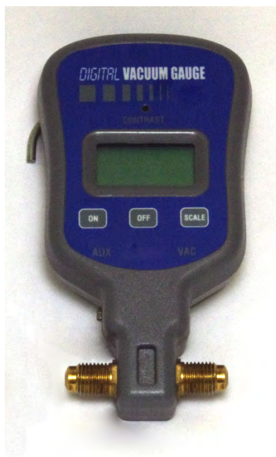
Figura C-16. Medidor electrónico de vacío en micrones
