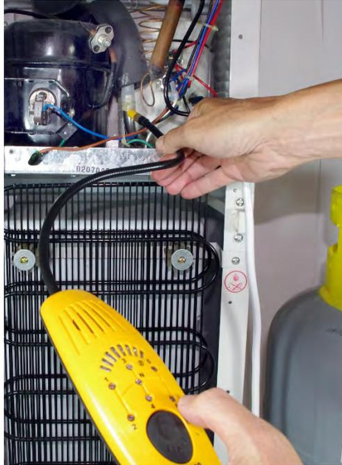
**Figura C-14. Detector electrónico de fugas**
