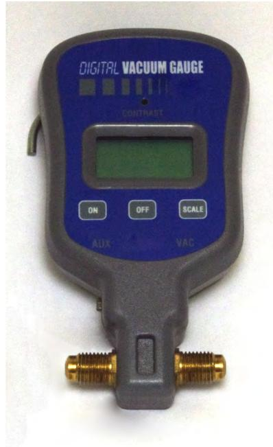
**Figura C-16. Medidor electrónico de vacío en micrones**
