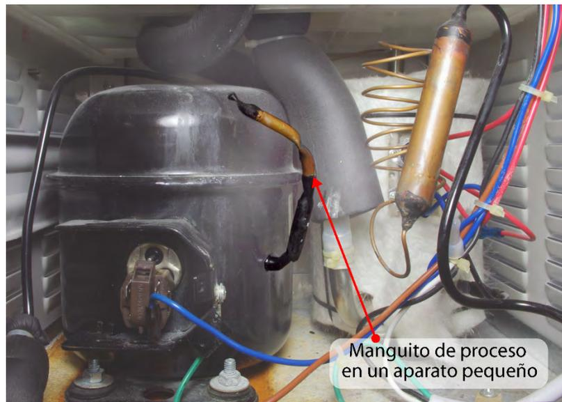
**Figura I-2. Manguito de proceso en un aparato pequeño con refrigerante inflamable**
