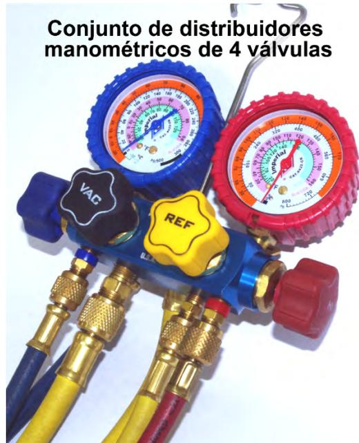
Figura C-6. Distribuidor de cuatro válvulas y cuatro mangueras
