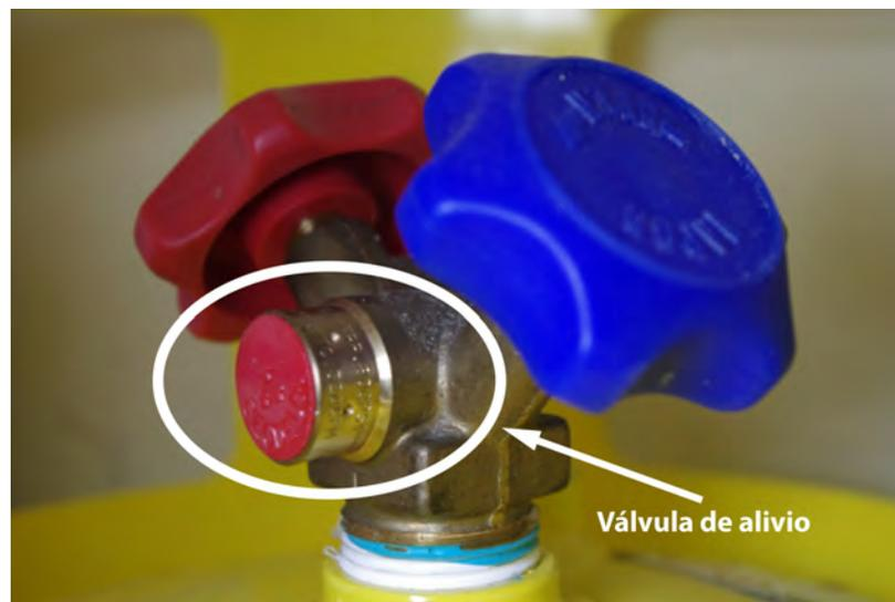
**Figura C-9. Válvula de alivio de presión en un tanque de recuperación**
